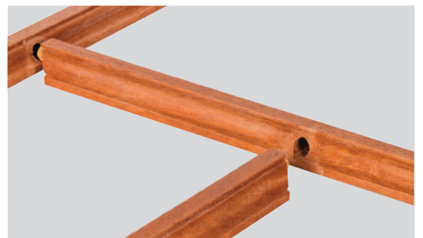
Petits bois intérieurs assemblés par tourillons avec la parclose.
