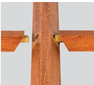
Petits bois extérieurs assemblés par tourillons et montés au cadre de l'ouvrant.
