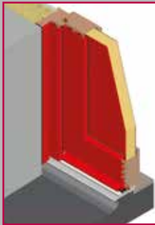
Pose en applique avec tapée d'isolation
