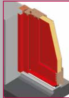
Pose en rénovation sur bâti existant
